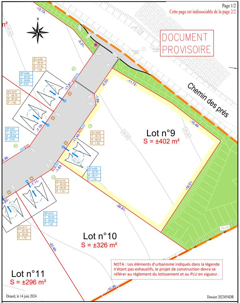
Nota: Le fond de plan est issus du plan topographique réalisé avant le démarrage des travaux. Il sera nécessaire de vérifier les cotes altimétriques avant le démarrage des constructions. La position et les cotes de nivellement des bornes seront mentionnées après bornage des lots.
